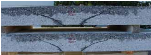
Рис.9. Характер разрушения плит перекрытия без усиления.
