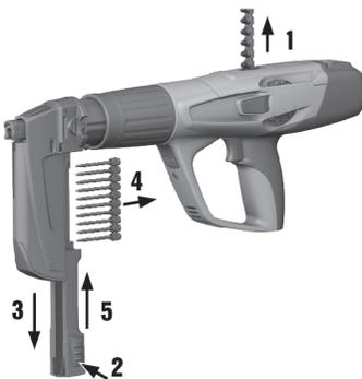
1. Ziehen Sie die Kartusche aus dem Gerät.
