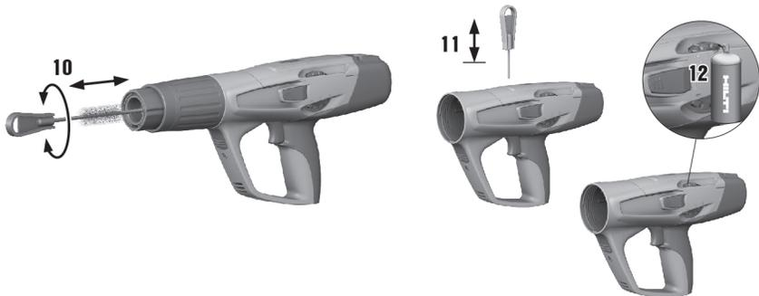
1. Sprühen Sie die Kolbenringe leicht mit Öl ein und reinigen Sie sie mit der flachen Bürste, bis diese frei beweglich sind.
