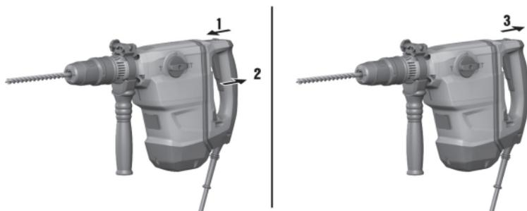
1. Deslice hacia delante el botón de fijación para marcha continua.
