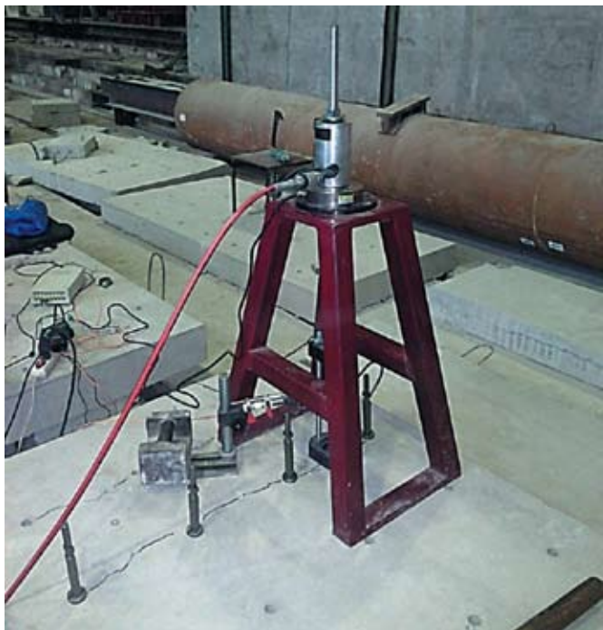
Рис. 1. Испытания на действие продольной силы в основании с трещиной
