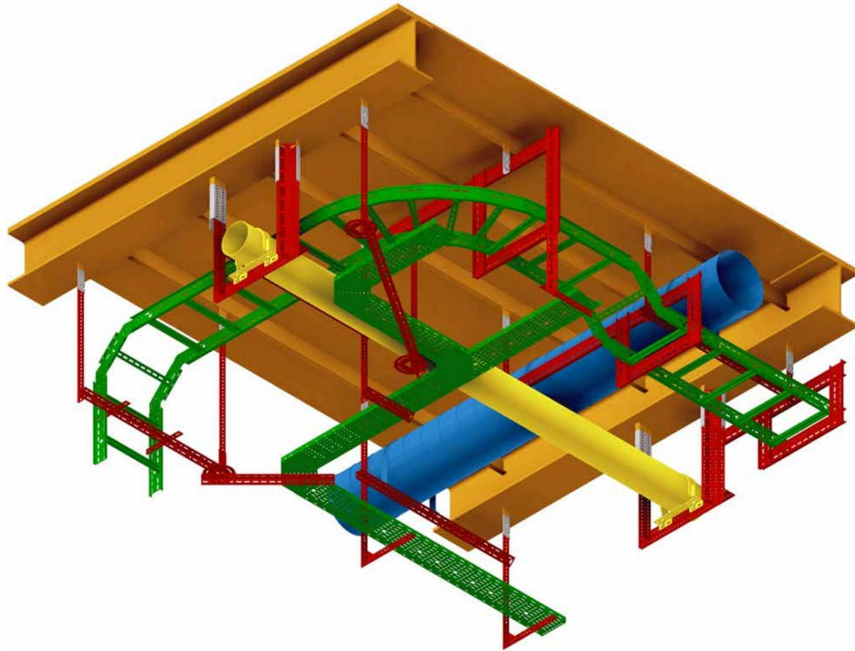
Чтобы обеспечить максимальную гибкость во время проведения монтажных работ и будущего расширения или адаптации системы, рекомендуем выполнять проектирование и установку, используя систему MultiGrid®. Опыт, полученный в результате 40 лет работы над проектами разного масштаба и уровня сложности, доказывает, что большинство систем требуют внесения изменений или адаптации во время строительных или монтажных работ.
