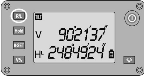
Η διάταξη μέτρησης για την οριζόντια μέτρηση γωνίας μπορεί να αλλάξει πατώντας το πλήκτρο **R/L** μεταξύ δεξιά – δεξιόστροφα και αριστερά – αριστερόστροφα.
