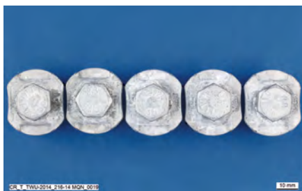
Рис. 18. Часть соединителя с многослойным покрытием (органическое ламельное покрытие) после десяти недель испытания по стандарту ISO 20340 с использованием УФ излучения.
