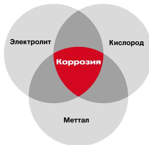
Рис. 2. Условия протекания реакции атмосферной коррозии.
