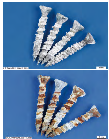
Рис. 14: Шурупы, прошедшие оцинковку электрогальваническим методом с толщиной цинкового покрытия 5 мкм, после 48 часов (вверху) и 96 часов (внизу) нахождения в соляном тумане.
