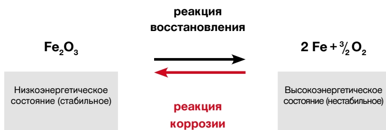
Рис. 1. Химические реакции с участием железа в ходе коррозии и процесса восстановления металла.
