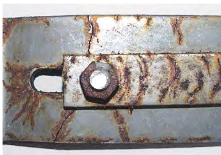
Рис. 8. КРН на скобе из марки стали 1.4301 (A2, 304) после около 4 лет использования в закрытом плавательном бассейне.
