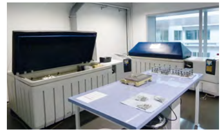
Рис. 13. Лаборатория коррозионных испытаний компании, оборудованная камерами для проведения различных испытаний на коррозионную стойкость.
