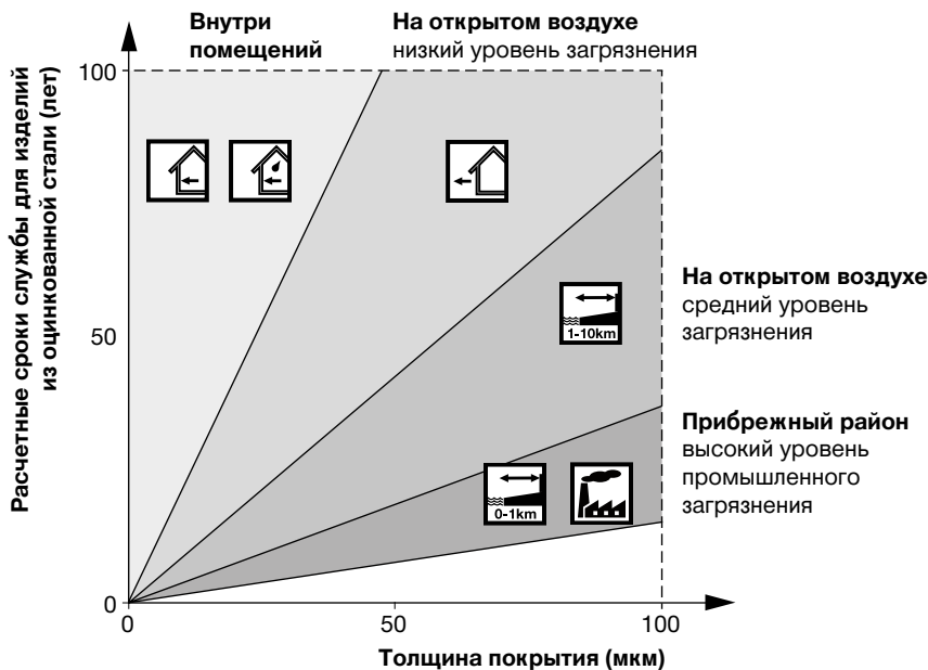
Рис. 29. Стандартный срок службы оцинкованной стали в различных условиях.
