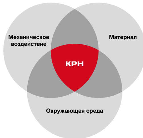
Рис. 9. Условия возникновения коррозионного растрескивания под напряжением.
