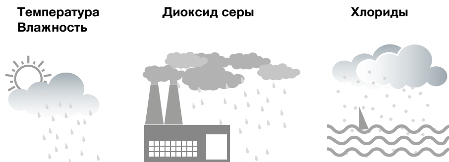
Рис. 36. Факторы, определяющие атмосферную коррозию.
