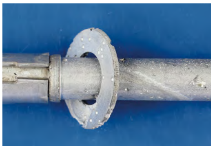
Рис. 5: Пример точечной коррозии на изделии из нержавеющей стали.
