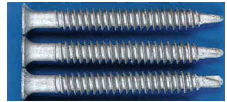
Рис. 20: Шурупы с многослойным покрытием с повышенной устойчивостью к коррозии после проведения испытания на коррозионную стойкость с использованием диоксида серы в течение 15 циклов (признаки коррозии отсутствуют).
