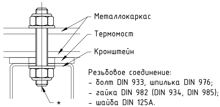
Крепление кронштейна НВФ к строительному основанию (металлоконструкция)
